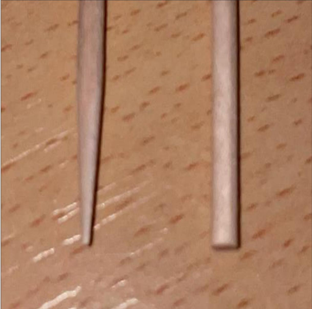
**Dazu einfach mit leichtem Druck und unter kontinuierlichem Drehen des Holzspießes solange schleifen, bis beide Enden über ein spitzes Ende verfügen.**
